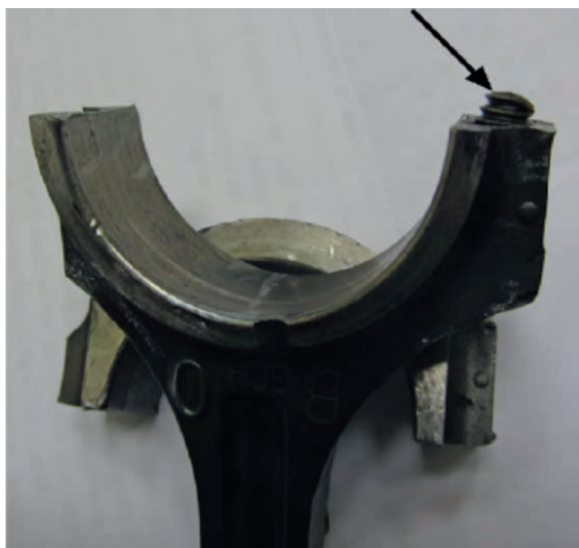
Рисунок 2 — Изогнутый шатунный болт (показан стрелкой)
