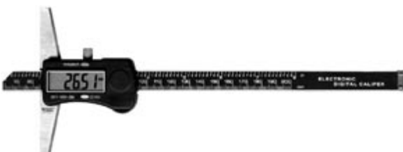
Фото 3. Глубиномер с цифровой индикацией
