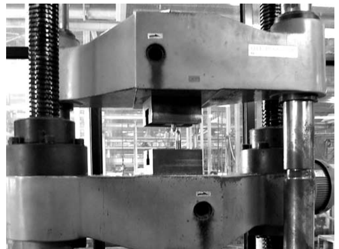
Рис. 13. Испытание болтов на минимальную разрушающую нагрузку
