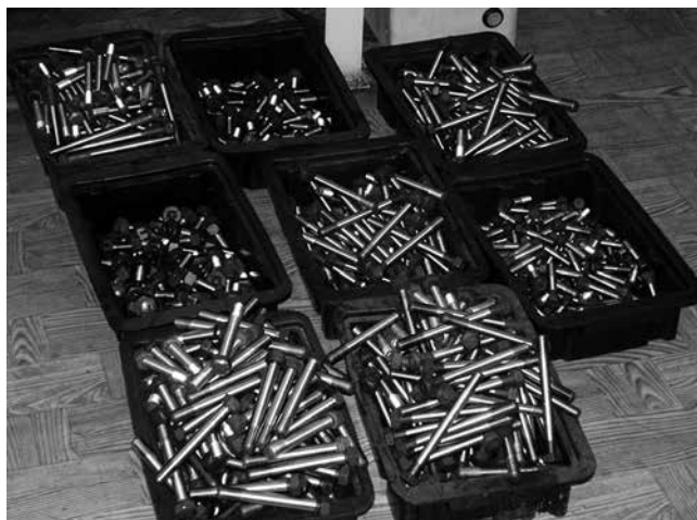
Рис. 9. Ответственные болты дизельных двигателей, возвращённые в производство после контроля их механических свойств неразрушающим методом
