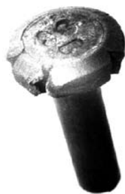
Рис. 2. Трещины напряжения при использовании материала с низкой пластичностью
