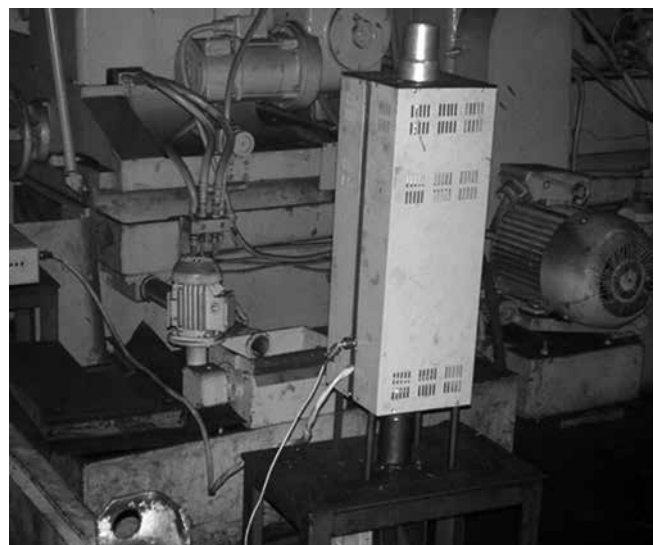
Рис. 6. Преобразователь прибора МАКСИ-Д на участке термической обработки болтов
