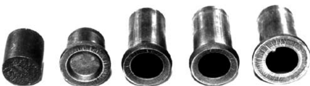
Рис. 3. Трещины напряжения вследствие затупления отрезного инструмента
